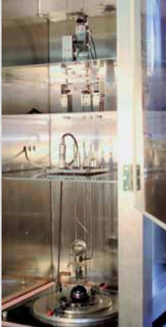
Unterflureinrichtung des Festkörperprüf- turmes: Dabei sind die Hebezylinder der Gewichtsstücke und die Aufnahme der Senkkörper und des Prüflings zu erkennen.
