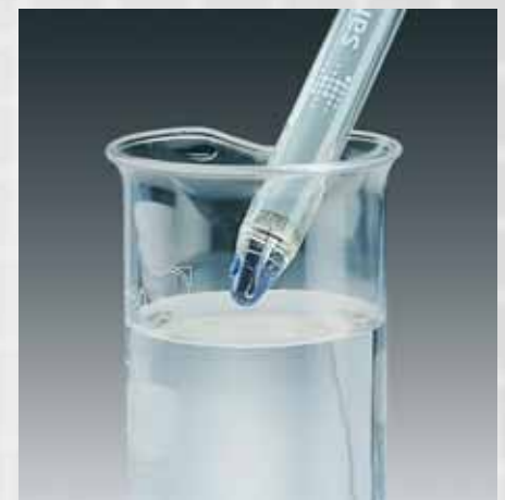
Die nachfüllbare pH-Elektrode PY-P11 mit Glasschaft, Platindiaphragma und integriertem Temperatursensor.
