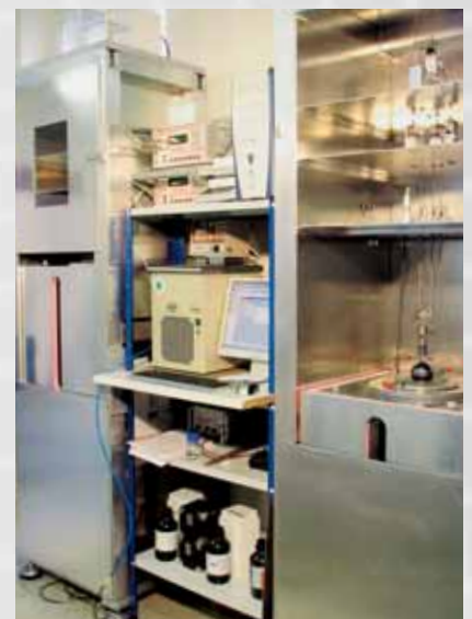
Im BEV aufgebauete Anlage zur Dichtebestimmung.
