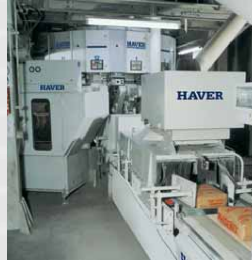
vorne rechts: Selbsttätige Kontrollwaage EWK 439 mit Wägesystem 60 kg D zur Regelung des 12 Stutzen Rotopackers (im Hintergrund) bei Phoenix Zementwerke Krogbeumker GmbH & Co. KG in Beckum.
