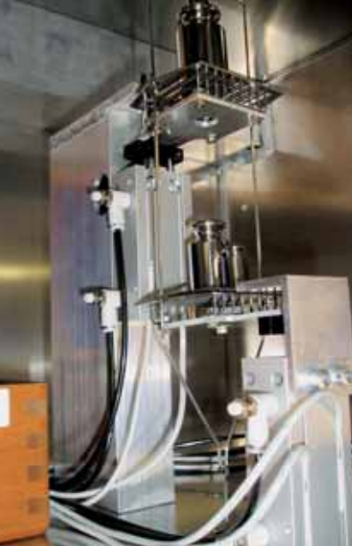
Gewichtaufnahme: Hubzylinder mit Waagengehänge.
