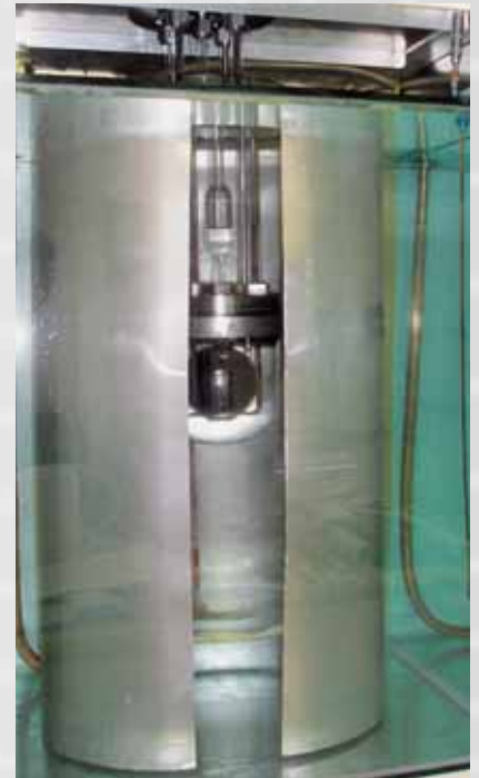
Leitbleche und spezielle Einlass- und Auslassrohre vermindern Temperaturschichtungen.
