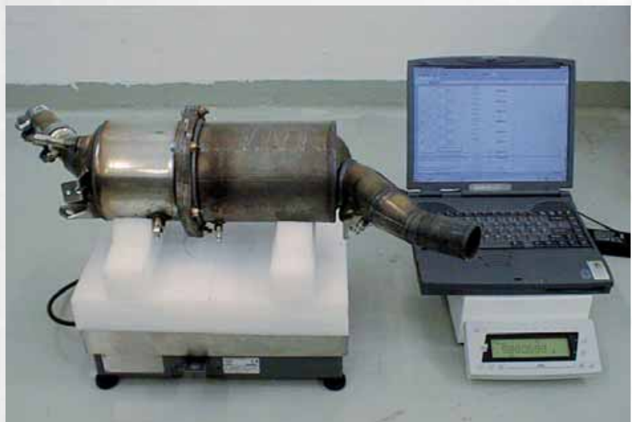
Der Massekomparator CC30002 mit einem Wägebereich von 40 kg und einer Auflösung von 1 mg meistert mit Bravour die Wägungen des Dieselpartikelfilters mit integrierten Oxidationskatalysator (CPDF).
