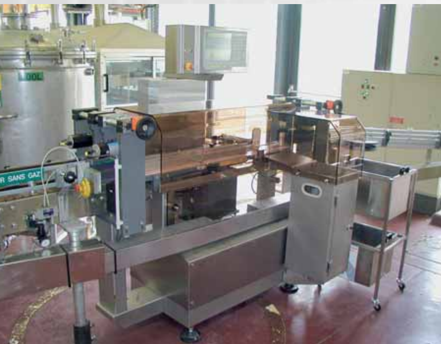
Checkweiger des Typs EWK2000PLUS mit Side-Grip-Bändern und abschließbarem Auffangbehälter zur Verwiegung von Haarspraydosen.
