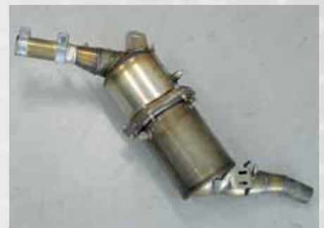
Der zu messende Dieselpartikelfilter mit integriertem Oxidationskatalysator.
