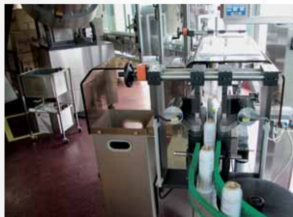
Höhen- und weiterstellbare Side-Grip-Bänder am Ein- und Auslauf der Kontrollwaage zur Übergabe und Beschleunigung der Haarspraydosen.
