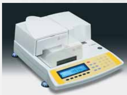
Feuchtemessgerät MA100: Thermogravimetrisches Feuchtemessgerät zur Bestimmung der Materialfeuchte.
