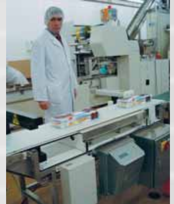
Der Betriebsleiter der Grabower Süßwaren vor dem Sartorius OBSERVER™, der die Verpackungen der Schaumküsse auf Metalldetektionen prüft.
