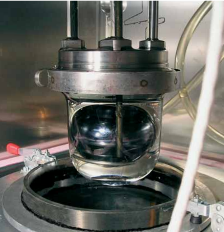
Tauchglocke mit Siliziumkugel als Senkkörper vor dem Anheben des Thermostatisierbades.
