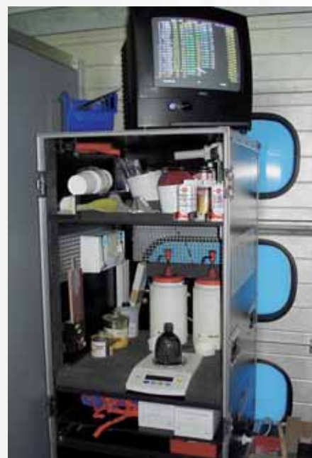
Die Wägedaten der Bremsscheiben werden mit der TE-Waage aufgezeichnet, um einen perfekten Aufbau zu realisieren.
