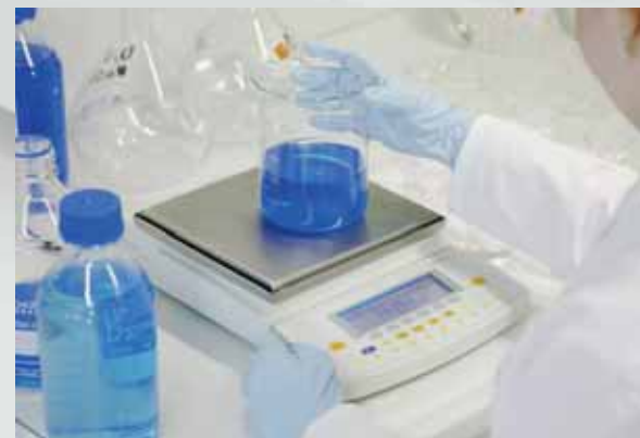
Die integrierte kalte Anzeigentechnologie macht die Analysenwaagen gegenüber den Aufstellungs- und Umgebungsbedingungen toleranter.
