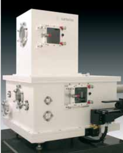
Mit dem Superkomparator CCL1007 können Gewichtsabweichungen im Nanogrammbereich bestimmt werden.
