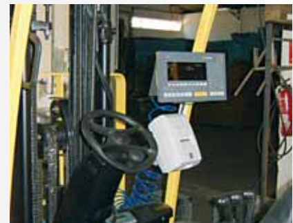
Die zu erfassenden Daten können schnell und pro-blemlos vom Fahrer des Hubwagens eingegeben und ausgedruckt werden.
