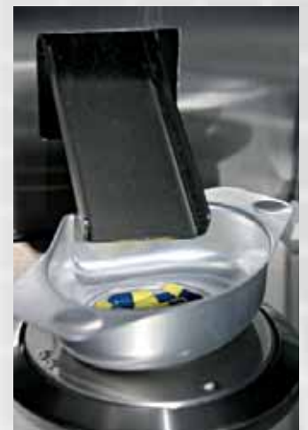
Über die Edelstahlrutsche gelangen die Tabletten einzeln in die Schale auf der Waagschale.
