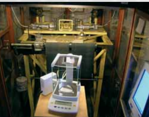
Die Semimikrowaage vor dem astatichen Horizontal-seismographen der Wiechert'schen Erdbebenwarte Göttingen.
