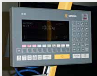
Staub- und Strahlwasserschutz ist mit dem Industrie-terminal ISI30 stets gewährleistet.
