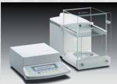
Die CCE36 mit einem Wägebereich von 31 g und einer Auflösung von 1 \mu\text{g} .
