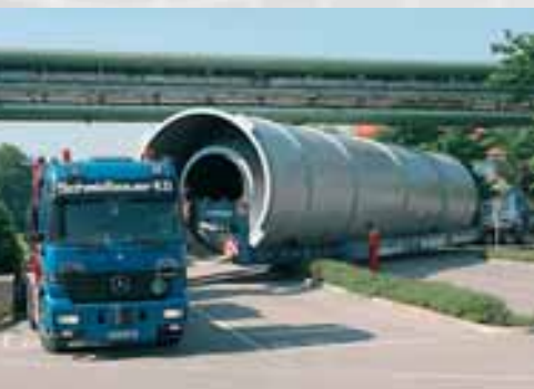
Der Transport des Silos zum Werk Burghausen der Wacker Chemie AG.
