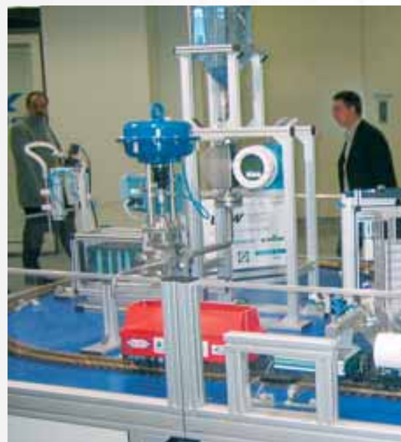
Die gesamte Miniaturanlage – ausgestattet mit Druckmesszellen, Plattformen, Profibus-Transmittern und Wägeindikatoren von Sartorius.
