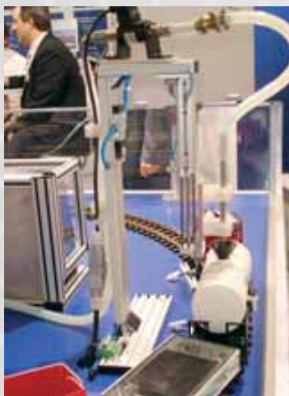
Flüssigkeit aus einem Silo kann in einen Waggon problemlos abgefüllt werden.
