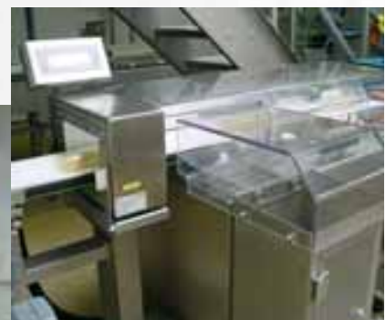
Kombi-checkweigher: Metallsuchgerät im Zuführband des Checkweighers integriert sowie die entsprechende separat aufgestellte Bedieneinheit.
