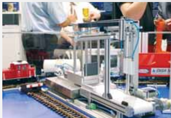
Der Einsatz der Combi-Plattform eignet sich für das Zählen von Stückgütern – hier im Modell für ein verpacktes Werbebesenken.
