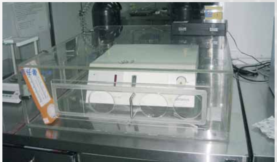
Das WDS 400 wird bei Weigao eingesetzt, um den Feuchtegehalt von medizinischem Nahtmaterial zu bestimmen.
