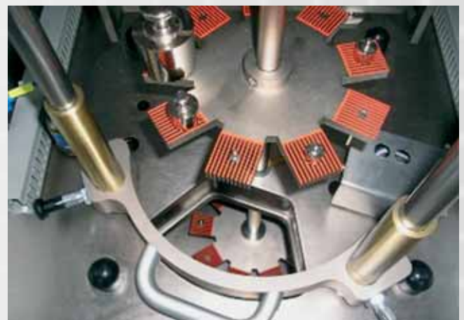
Abb. 3: Magazin der Substitutionsgewichte, Einbringvorrichtung und Draufsicht auf das Magazin der Messzelle.
