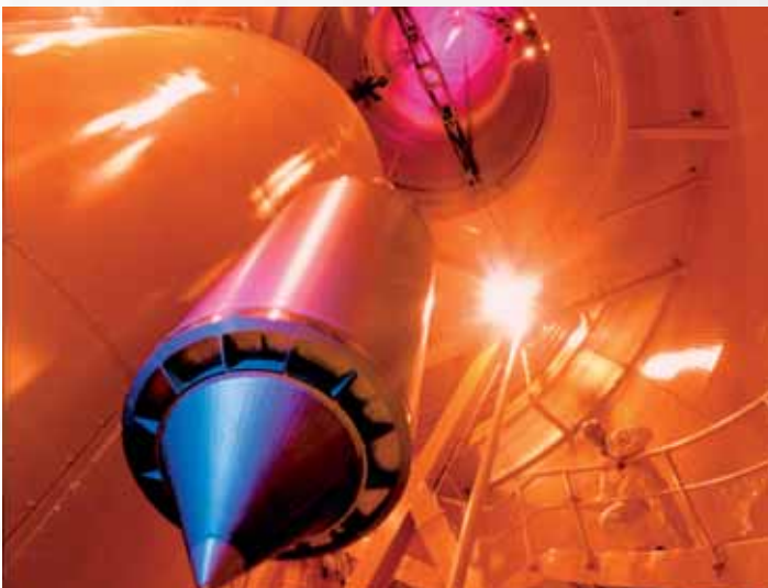
Das Innere des Fallturms, in dem die Experimente zur Schwerelosigkeit durchgeführt werden.
