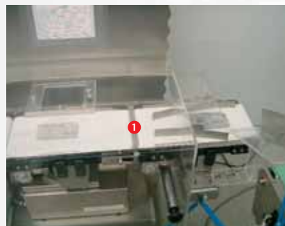
Die Übergangsleiste aus Edelstahl verkleinert die Lücke zwischen den beiden Bändern und schaltet Vibrationen aus [1].
