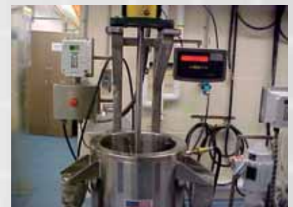
Komplette Behälterwägesystem mit dem Wägedindikator Combics 1.
