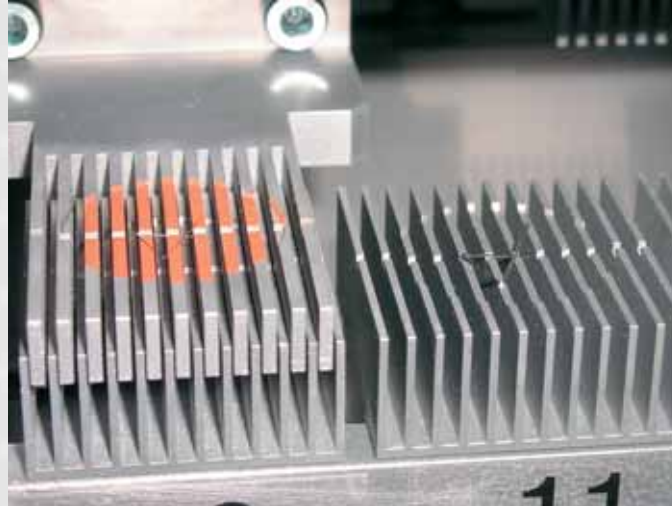
Gewichtaufnahme, Konstruktion und Realität (Aufnahme 1 mg und 2 mg Drahtgewicht).
