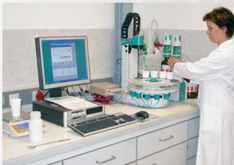
Automatische Übertragung der Messwerte von der Laborwaage an den PC.
