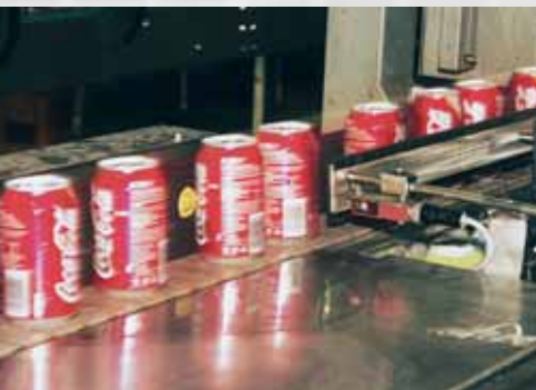
Auf der Dosenlinie verlassen bis zu 72.000 der weltbekanntesten Coca-Cola Dosen stündlich das Band.
