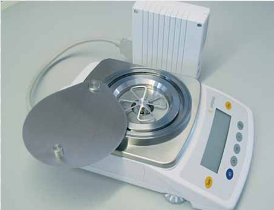
Der extra für diese Anwendung konstruierte Windschutz ist komplett aus Metall gefertigt, so dass elektrostatische Effekte bis auf ein Minimum reduziert werden.
