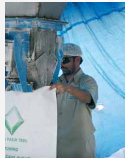
Der Bediener muss den Sack nur noch in Position bringen und den Abfüllzyklus durch Knopfdruck starten.
