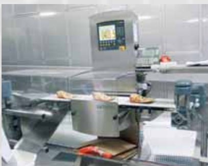
Mit einer Durchsatzleistung von 100 St./min kontrolliert der Synus Checkweigher das Gewicht der Knödeltüten.
