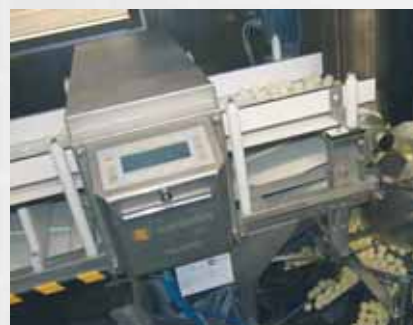
Der Metalldetektor MDP garantiert, dass die Produkte, die in den Handel kommen, frei von metallischen Verunreinigungen sind.
