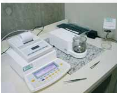
Mit der ME5 wird sowohl der Masseverlust als auch die kondensierbaren Anteile verwogen.
