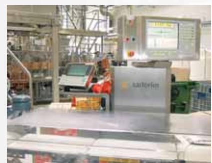
In der zweiten Produktionslinie kontrolliert ein EWK 3000 Checkweigher das Gewicht.
