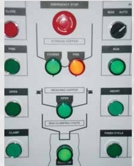
Die Bedienkonsole erlaubt die manuelle Bedienung der wichtigsten Funktionen über Drucktasten und die Prozessüberwachung mittels LED.
