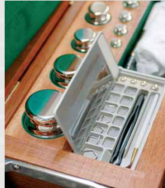
Einer der Sartorius Gewichtssätze zum Überprüfen der Waagen.
