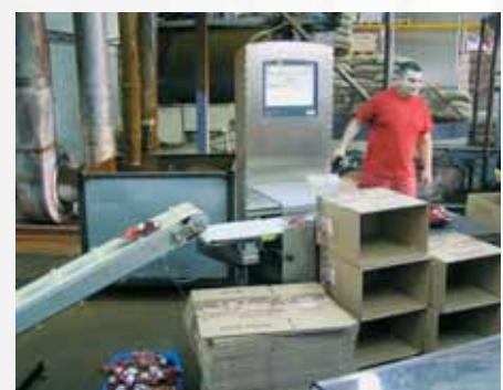
In die Verpackungsanlage integrierte SYNUS®-Kontrollwaage.
