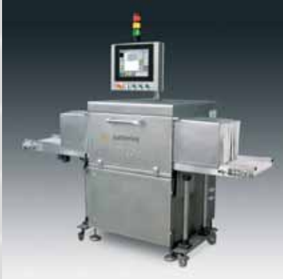
Röntgeninspektionssystem Dyxim FB80.
