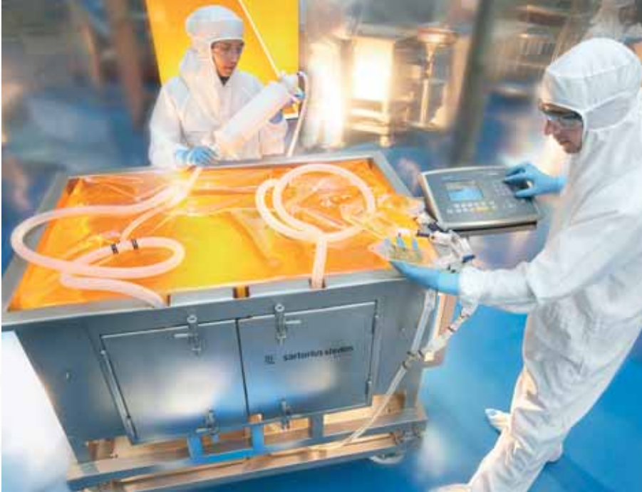
Das Combics Pro Wägeterminal bei der direkten Anbindung an die Stedim-Einwegbeutel.
