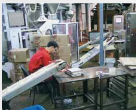
LA-Waage für die Gewichtskontrolle der Cappuccino-Packungen.
