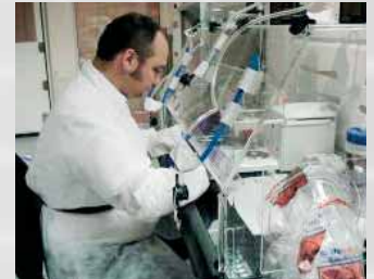
Wägekabine mit Testsensoren, um Naproxen-Natrium nachweisen zu können
