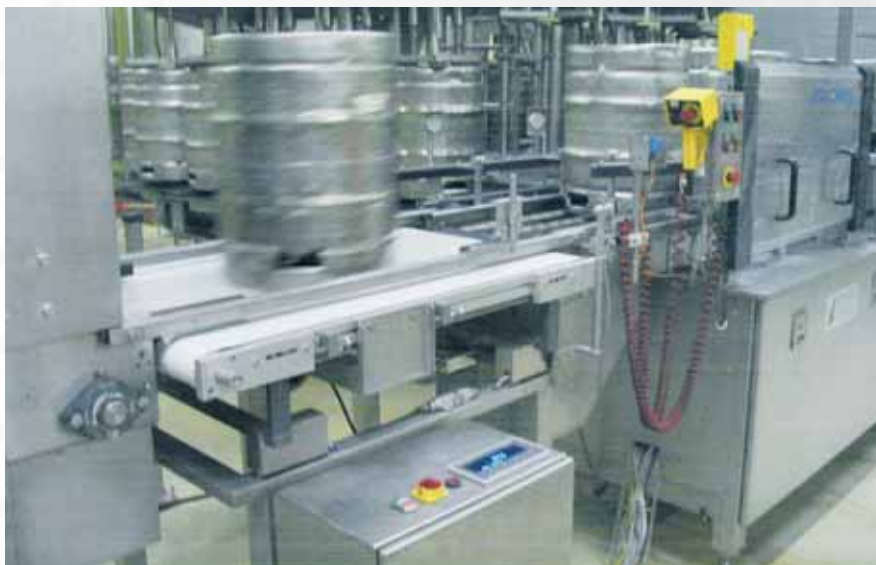
Am Display des X4 Prozesscontrollers erkennen die Mitarbeiter Über- und Unterfüllung auf einen Blick.
