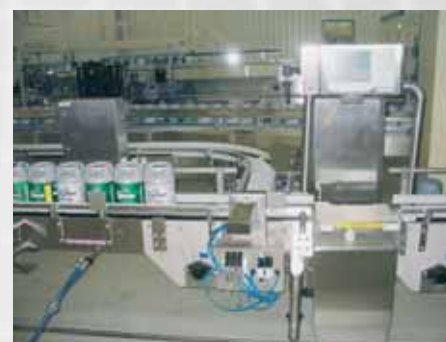
Wägung der Bierfässer auf Über- und Unterfüllung.
