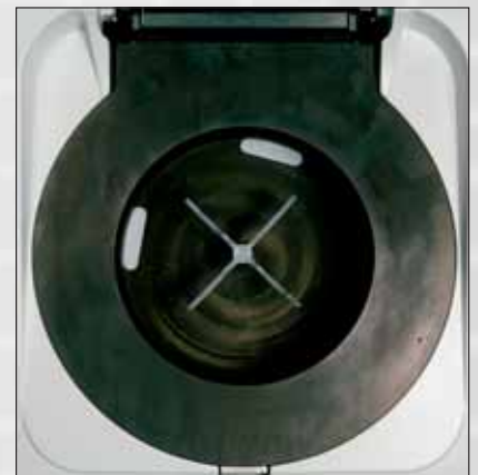
Bild 4: Probenraum mit Probenträger und Einleitung der Mikrowellenstrahlung.
