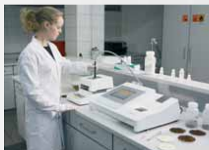
Der Messkopf ist über ein Glasfaserkabel angeschlossen, so dass Messungen auch direkt im Produktionsprozess vorgenommen werden können.
