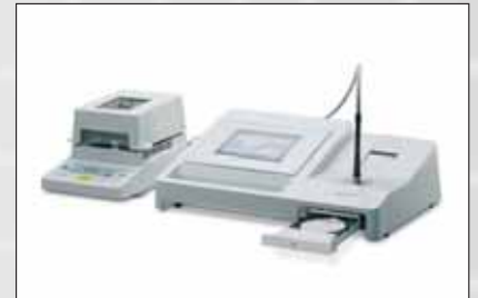
Der LMA500 kann für Messungen an schütt- und rieselfähigen Produkten eingesetzt werden.
