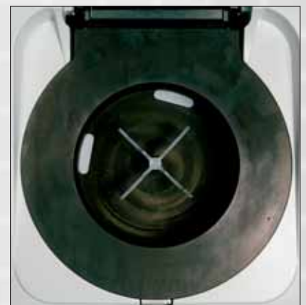
Bild 4: Probenraum mit Probenträger und Einleitung der Mikrowellenstrahlung.
