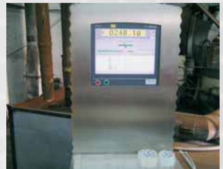
SYNUS®-Kontrollwaage in der Verpackungsanlage.
