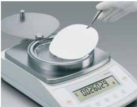
Speziell für die Wägung von Filtern entwickelt: Die CPA2P-F, z.B. zur Partikelmengenbestimmung in Verbrennungsvorgängen.
